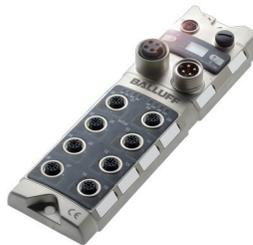
Módulo de red para la conexión al controlador
